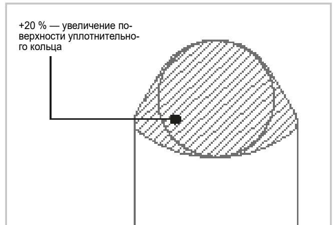
Рис. 12. Профиль уплотнительного кольца.
