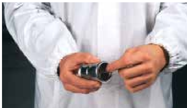
Рис. 30. Проверка уплотнительного кольца.
